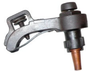
Dispositif d'allumage avec cartouche comme équipement supplémentaire en 1893 pour le canon de montagne de 7,5 cm de 1877.
