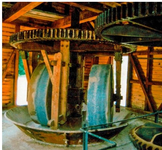
Moulin à rouleaux encore utilisé aujourd'hui, également appelé « Kollergang ».
