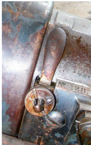
Dispositif d'allumage Gressly sur le canon de 12 cm, 1882.
