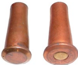
Cartouches pour le dispositif d'allumage Gressly, à gauche allumage périphérique et à droite allumage central.
