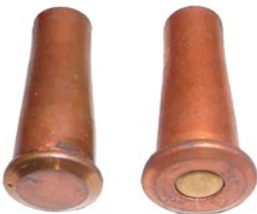
Zündpatronen für die Zündvorrichtung Gressly, links Randzündung und rechts Zentralzündung.
