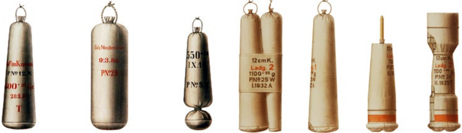
Ladungen für die 8,4 cm Kanone 1879: – Mitte Ausführung 1880 – Links Ausführung 1893 – Rechts Ausführung 1916
