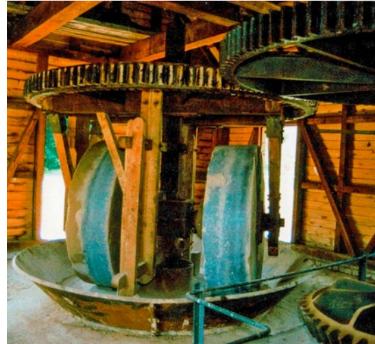
Heute noch gebräuchliche Läufermühle, auch Kollergang genannt.
