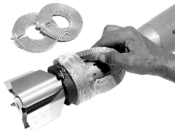
Fixation de la charge sur l'axe du tube pour des munitions modernes de 12 cm et 8,1 cm.
