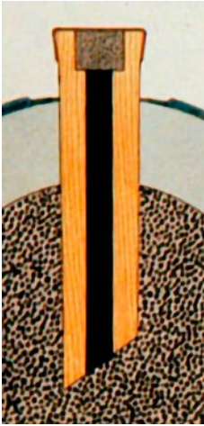
Mèche avec cheville en bois Ordonnance 1843, pour armes à chargement par la bouche à canon lisse.
