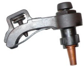
Zündvorrichtung mit Zündpatrone als Nachrüstung 1893 für die 7,5 cm Gebirgskanone 1877.
