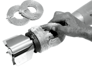
Ladungsanbringung am Flügelrohr bei 12 cm und moderner 8,1 cm Munition.
