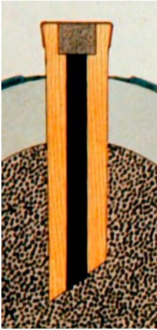
Brennzünder mit Holzzapfen Ordonnanz 1843, für glatte Vorderlader.
