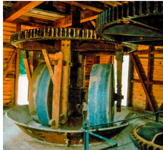
Heute noch gebräuchliche Läufermühle, auch Kollergang genannt.
