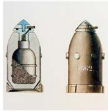
Grenade explosive de 4 livres, modèle 1862, avec points de rupture (préfragmentation) à l'intérieur de l'enveloppe antiéclats.
