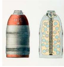
Grenade à balles et charge explosive centrale avec détonateur à retardement pour le canon de 8 livres de 1869.
