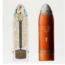
Obus de type Shrapnel pour canons de campagne de 7,5 cm de 1903, avec bourre de boules de plomb, fusée à temps et charge d'expulsion dans la base du projectile.
