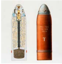
Schrapnell der 7,5-cm-Feldkanonen um 1903 mit Kugelfüllung, Zeitzünder und Ausstossladung im Geschossboden.
