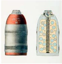
Granate mit Kugeln und mittiger Sprengladung mit Zeitzünder für die 8-pfdr-Kanone 1869.
