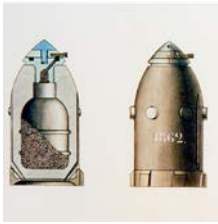
4-pfdr-Sprenggranate Ordonnanz 1862 mit Sollbruchstellen (Vorfragmentierung) auf der Innenseite des Splittermantels.
