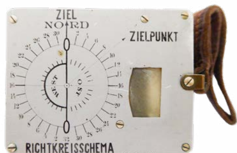
Premier modèle de sitomètre de l'armée datant de 1915 (désigné dans le règlement comme « Universel »).
