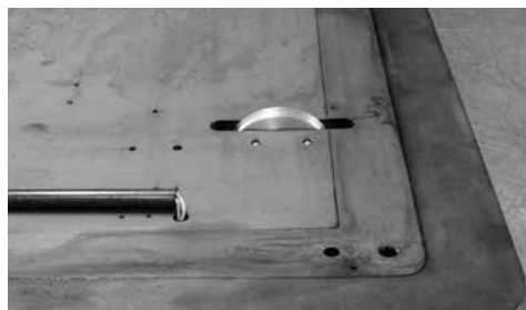
Photo 5: Traces d'anciens lubrifiants sur le côté verso de la table n° 3
