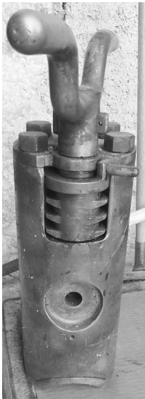
Culasse avec trou taraudé visible servant à visser le système d'allumage par friction.
