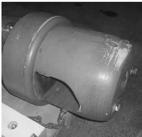
Bloc-culasse du tube n° 1 avec le trou de taraudage, visible en haut à droite, pour l'allumage moyennant le bras de levier.
