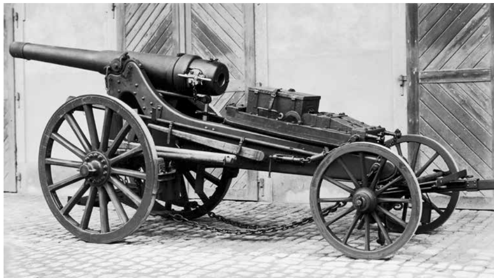
Configuration de transport de la pièce 1916 après l'introduction des ceintures de roues, des arcs de recul (chargés séparément) et du frein à sabot.
