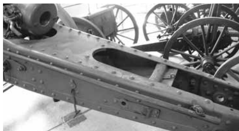
Affût avec renforcements inférieurs et supérieurs fixés par rivetage.
