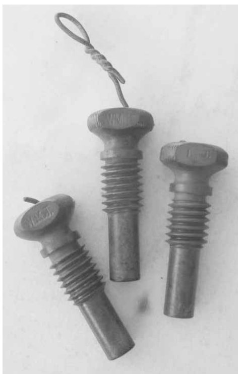
Système d'allumage par friction Krupp. En Suisse, on désigna ce dispositif d'allumage sous une forme ultérieure non vissable par le terme d'étouille.
